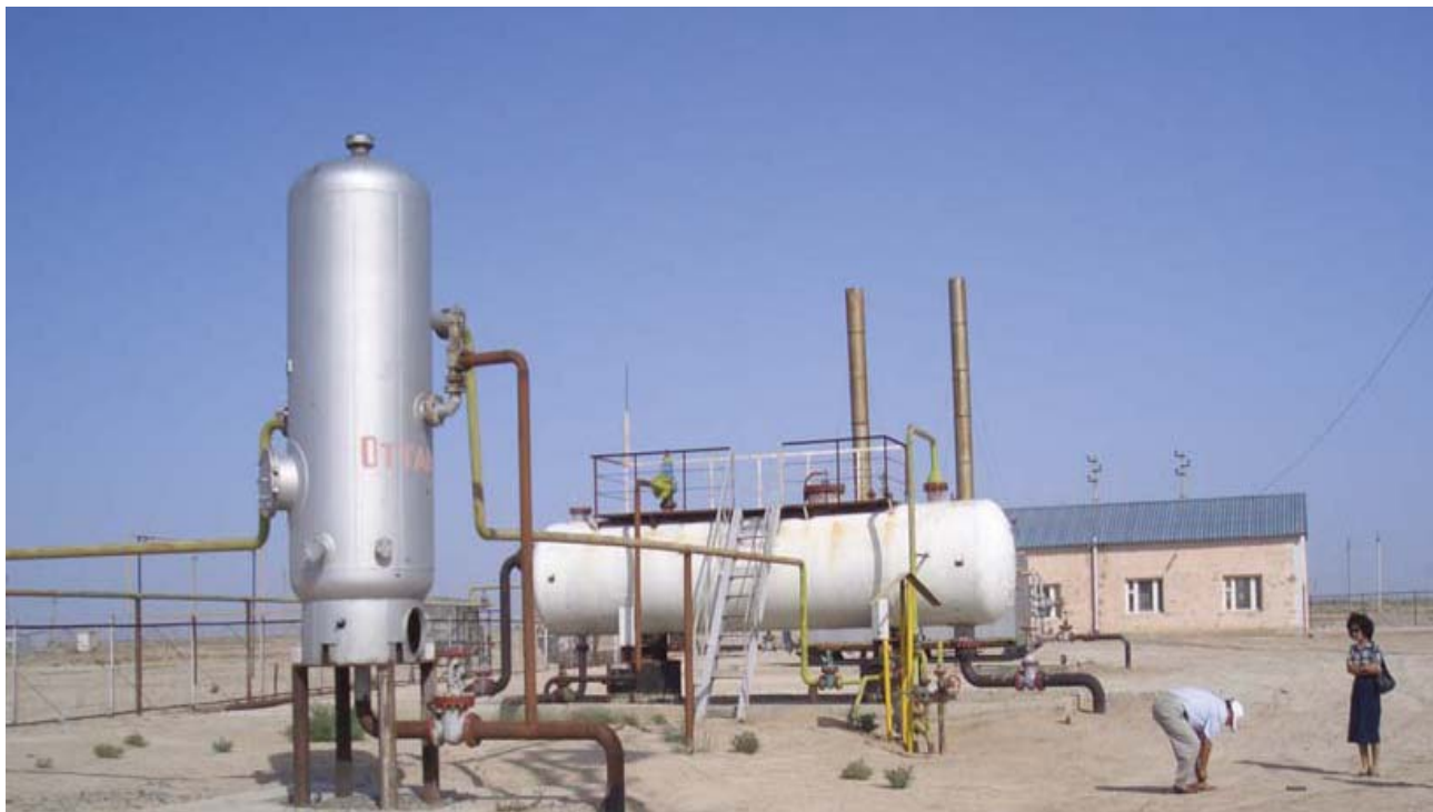
НГДУ Жаикмунайгаз. Месторождение Жанаталап. Сепаратор первой ступени и УПСВ.
